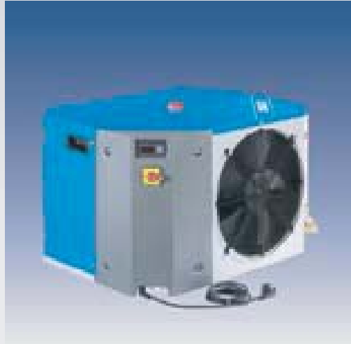
Refroidisseurs compacts CHILLY - Refroidisseurs d'eau d'une puissance frigorifique de 0,8 à 4,5 kW avec bac et pompe intégrés. Fiabilité et faible encombrement.
